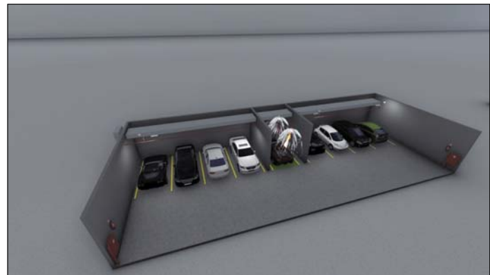
Nicho separado por barreiras verticais, com dois pontos de "chuveiros automáticos" e TRRF-90
